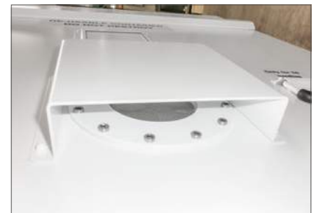
Sicherheitselement Berstscheibe: Schutz bei plötzlichem Druckabfall in der Umgebung
