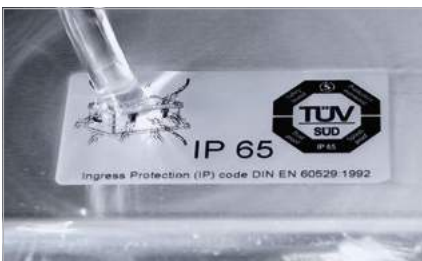
Strahlwasserschutz nach Norm IP 65
