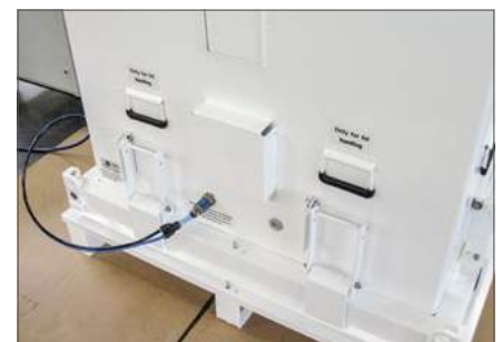
Wasserdampfdichter Behälter bei Dichtheitsprüfung durch Überdruck
